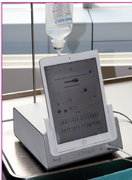
Abb. 3: Bien-Air ermöglicht präzises Arbeiten durch exakte Steuerung des Drehmoments in jedem Arbeitsschritt. Zusätzlich wird automatisch ein Protokoll der einzelnen Arbeitsschritte erstellt.
